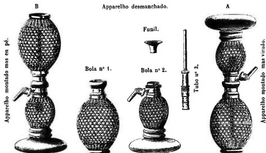
Fig. 15. — Apparelo gazogeneo para preparar agua gazosa.
